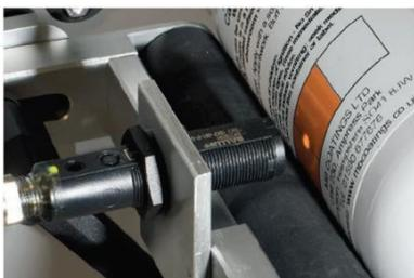
Sensor de etiqueta para indexación. Permite aplicar etiqueta en función de una marca específica del producto.
