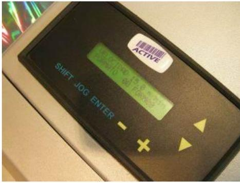
Controlador con micro-procesador de 32 bits con tecnología SMD Autoaprendizaje. Display LCD de 2 líneas. Ajuste total de ciclos. Memoria de 40 formatos pre-programados.
