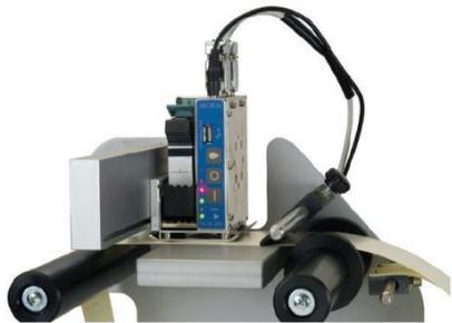
La T200 puede ser equipada con un sistema de impresión integrada. Por inkjet, o por transferencia térmica TTR que integramos.
