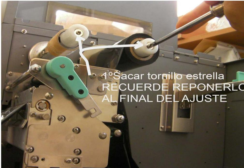
Comprobar girando manualmente sobre el ribbon, el avance del tornillo que sujeta el muelle del disco lateral de eje-ribbon.
