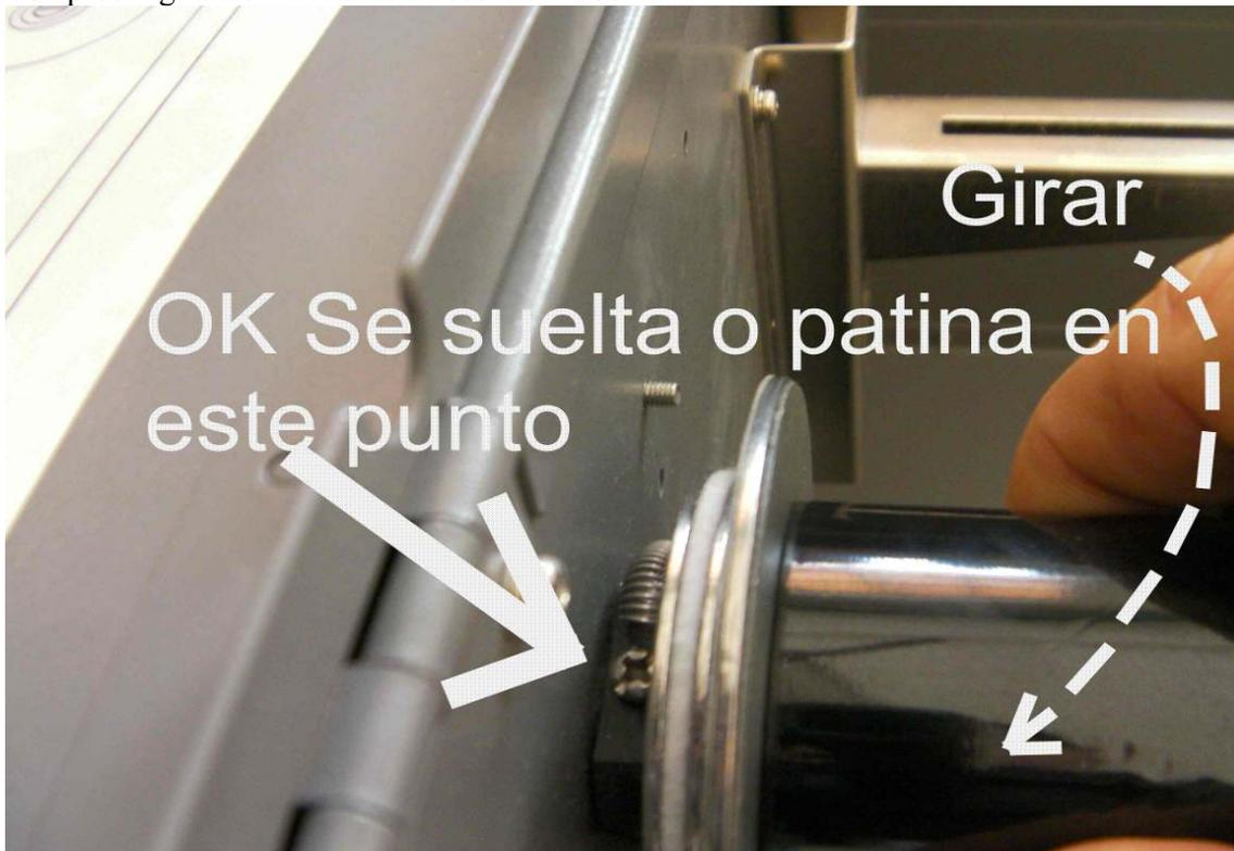
Parece buena esta posición en la que al girar se suelta este eje-retén. Probar y ver resultados Si se sigue rompiendo aún se puede volver aflojar. y probar.
