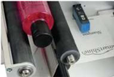
Sensor de etiquetas por GAP, transmisor y opción de sensor de modelo especial para etiquetas transparentes.
